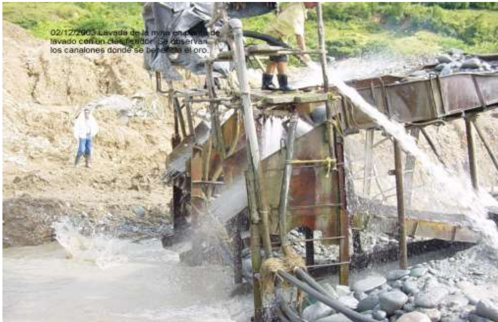
Foto: Proceso de beneficio tomado explotaciones realizadas por la Cooperativa "El Samán" en periodos anteriores en la cual se observa que todo el beneficio del mineral se realiza exclusivamente gravimétricos.
