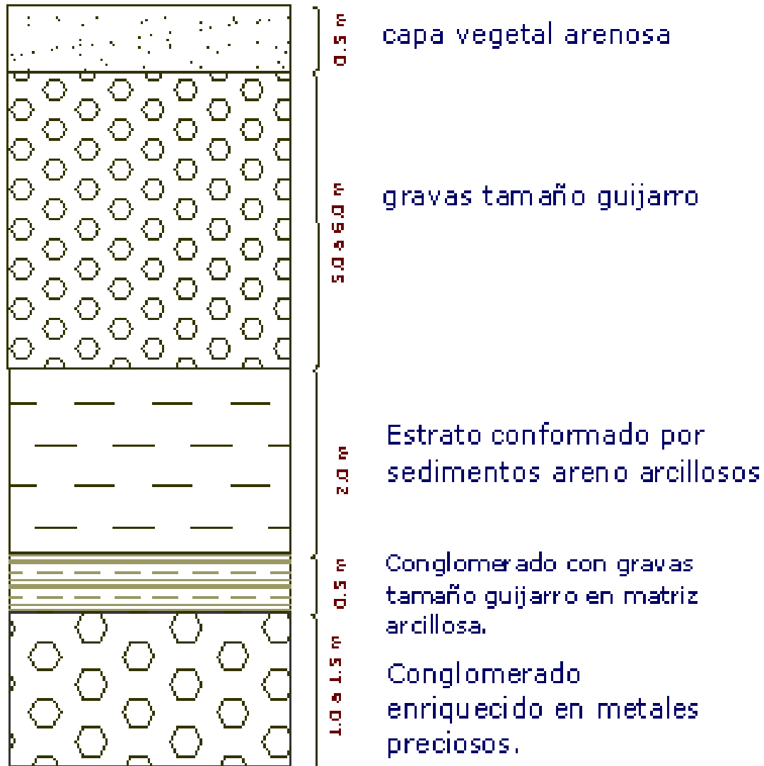
Figura 4.6 Columna estratigráfica generalizada de los depósitos aluviales del área de influencia.
