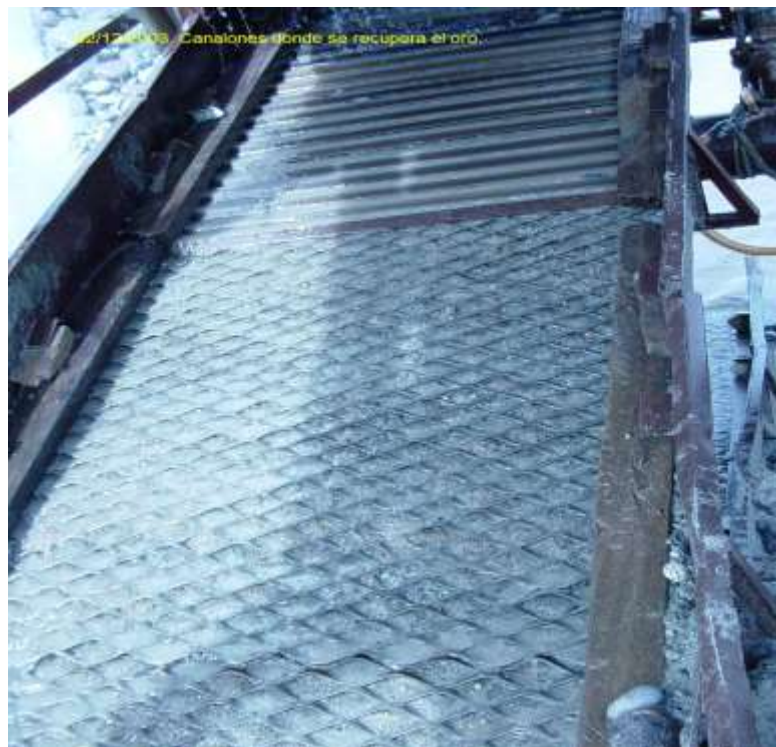
Foto: Proceso de explotación tomado explotaciones realizadas por la Cooperativa "El Samán" en periodos anteriores en la cual se observa que todo el beneficio del mineral se realiza exclusivamente por medios gravimétricos
