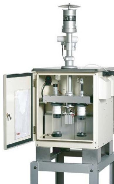
Figura 12.6. Muestreador Semiautomático
