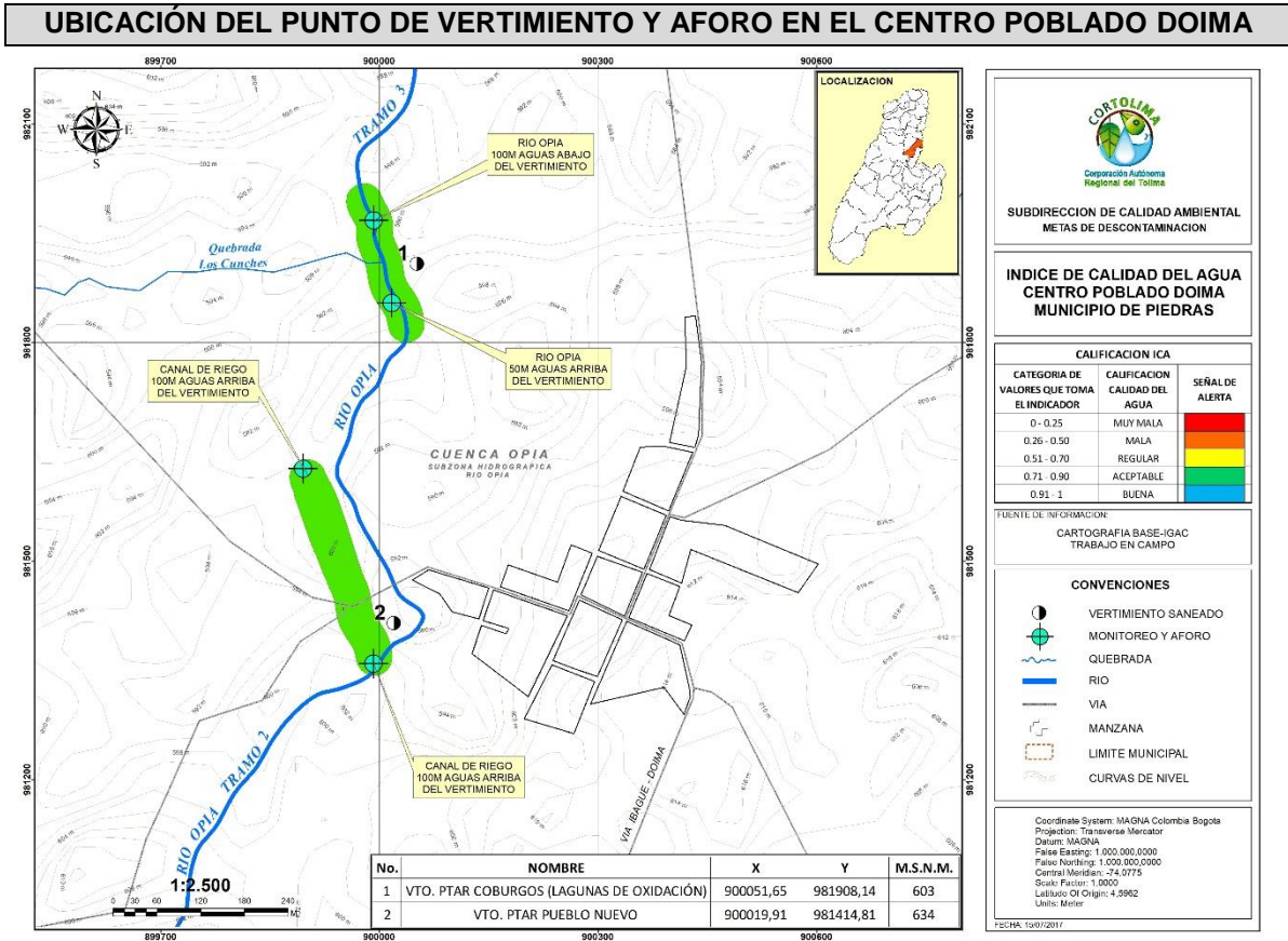
Figura 2. Ubicación punto de vertimiento del centro poblado DOIMA del Municipio de Guamo, Tolima Año 2017
